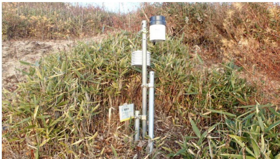
図7 斜面観測サイト南斜面に設置した雨量計
