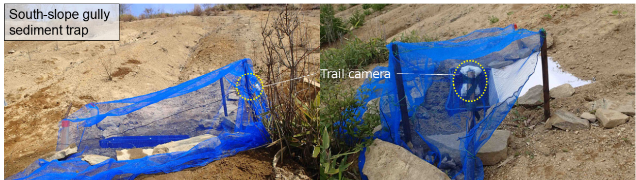
図6 南斜面ガリーからの流出土砂トラップ
