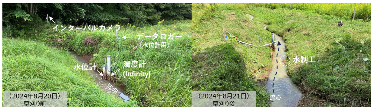
図3 流域土砂流出観測点
