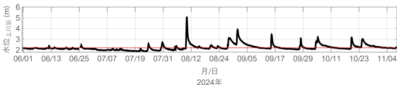
図4 2024年に上川沿観測所において計測された水位変動 (赤線は閾値水位を示す)
