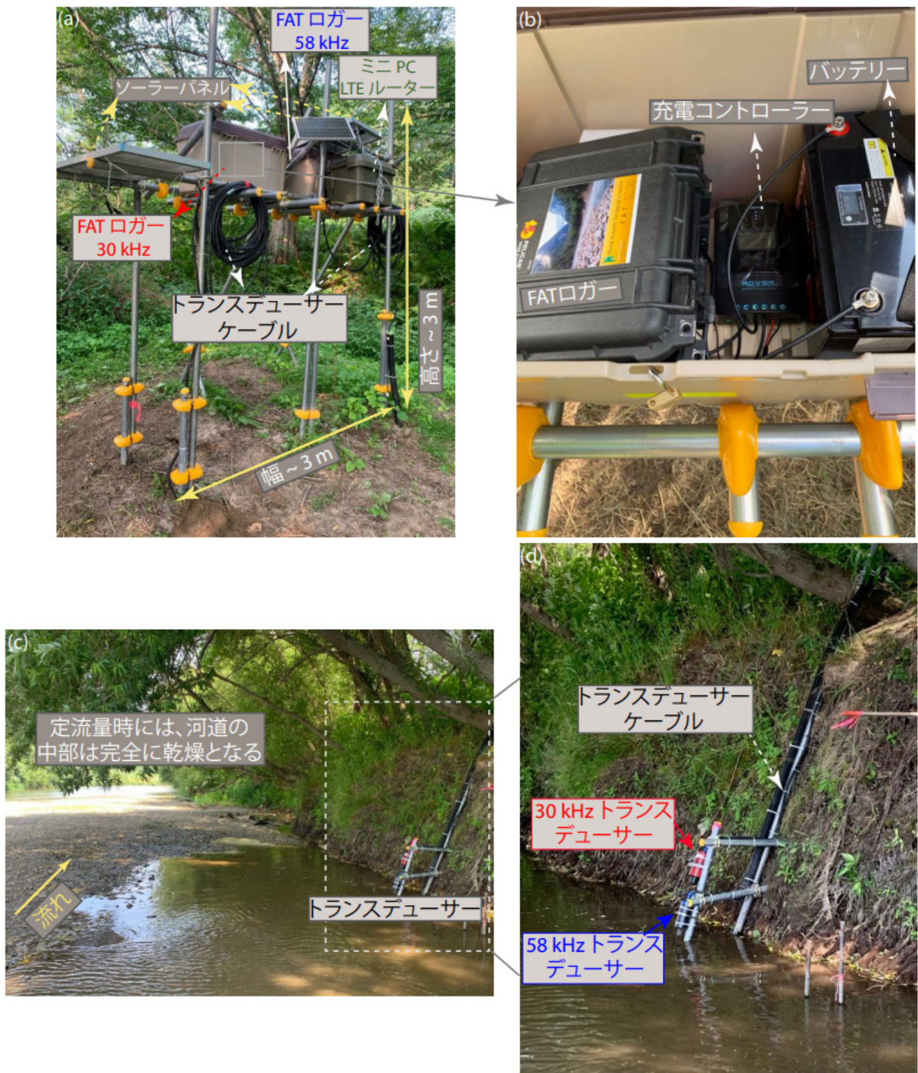
図2 a) 右岸に設置されたFAT監視ユニット, b) FATシステムロガーとバッテリー, c) 浅い流れの条件下における右岸での水中トランスデューサの設置, d) トランスデューサ設置の詳細図
