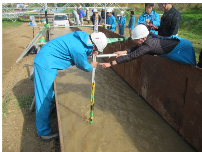
図2-5 電磁流速計（LP-40）による流量計測の様子
