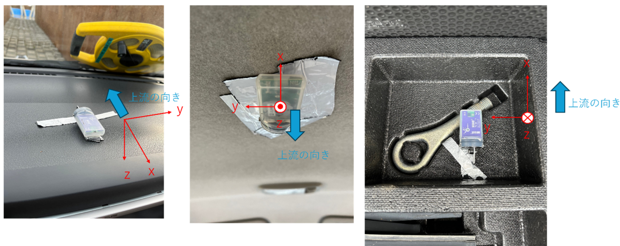
図2-4 車体内の3箇所に設置した加速度計
