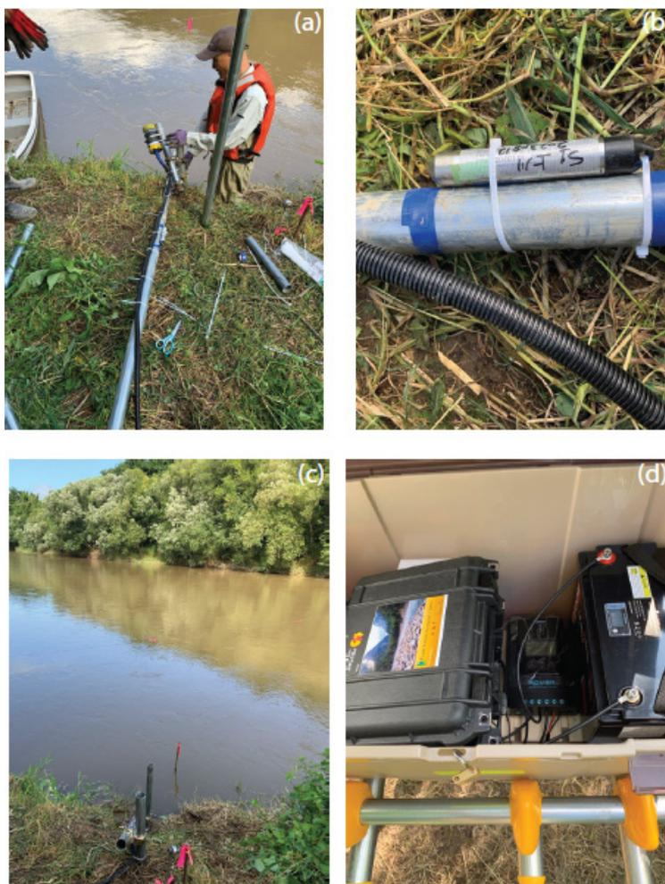
図3 FATシステムロガーと河川サイトへの設置
