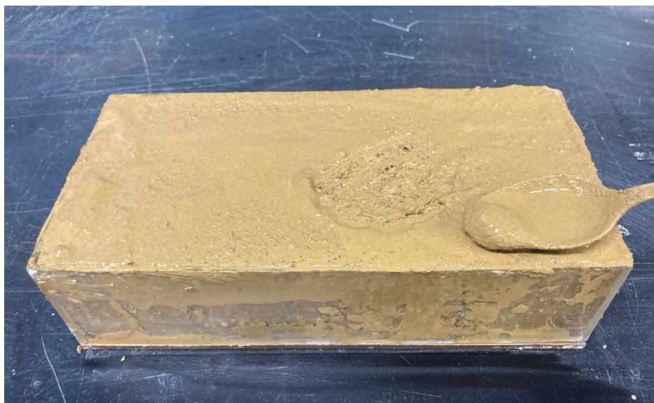
図6 En-a試料加振後の表面の泥濘化
