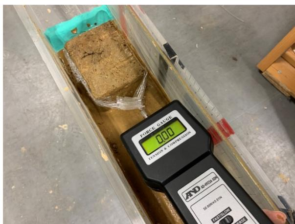
図14 動摩擦係数計測方法
