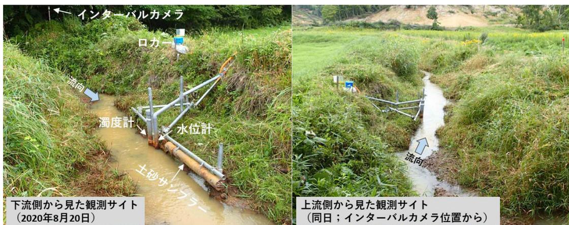
図2 流出観測サイトでの観測機材設置状況
