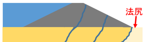
Case4(基礎地盤を飽和させ法尻まで浸透)
