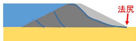
図9-5 越水時の浸透状況の違い
