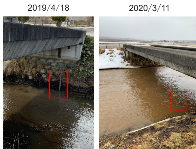
写真5-5 融雪期と降雨が重なった時の水位比較（左：降雨無し，右：降雨有り）
