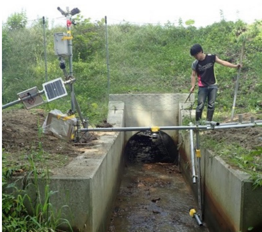
図3-16 水文観測地点の概観 7月25日撮影。右岸に設置された複合濁度計 水面上方に設置された超音波水深計
