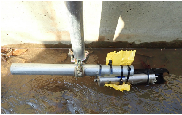
図3-18 複合濁度計 11月13日撮影
