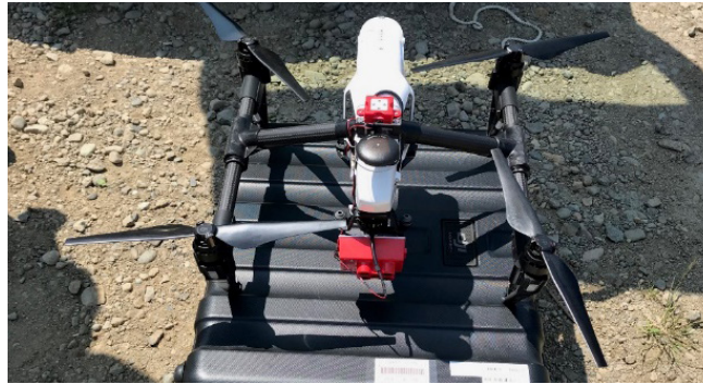
図2-15 マルチスペクトルカメラRedEdge-MX (MicaSense) を搭載したInspire1 (DJI)
