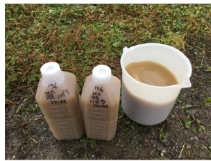
図2-11 採水資料（左），採水資料に含まれる細粒砂成分の出現比率
