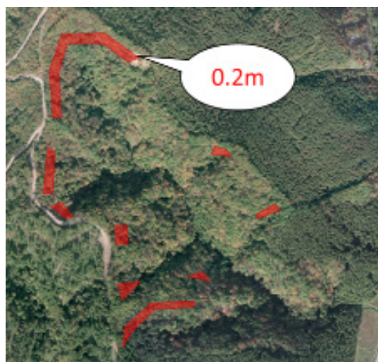
図1.7 高丘地区の数値シミュレーションに用いた斜面崩壊の形状と深さ（単位：m）
