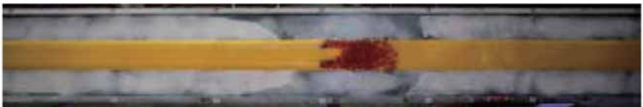
図-4.3 アイスジャム発生時の状況（流下方向は右から左，黄色が低水路）
