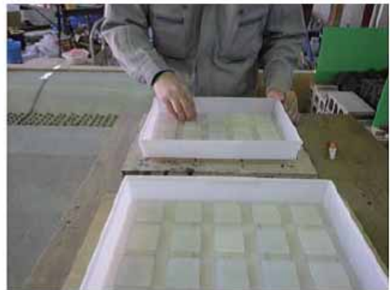
氷板模型敷き詰め作業
