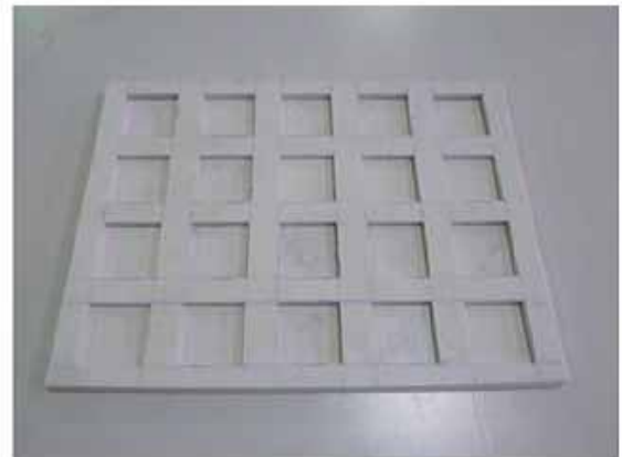
氷板製作用型枠完成(20枚分)
