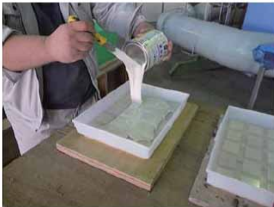
型取り材流し込み作業
