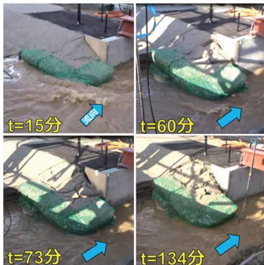
図14 対策工有りの模型盛土の侵食状況
