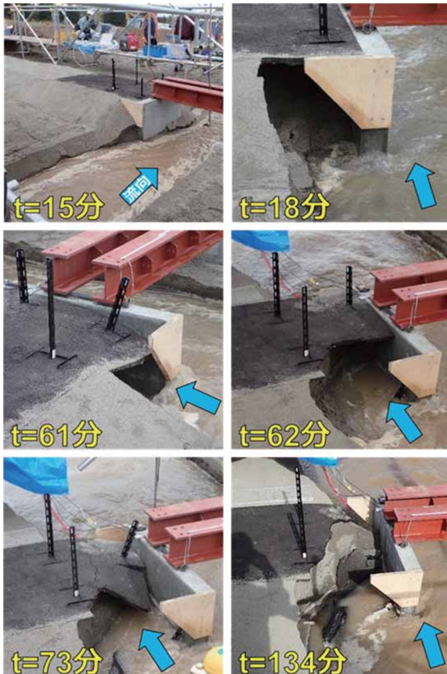
図6 対策工無しの場合の模型盛土の侵食状況
