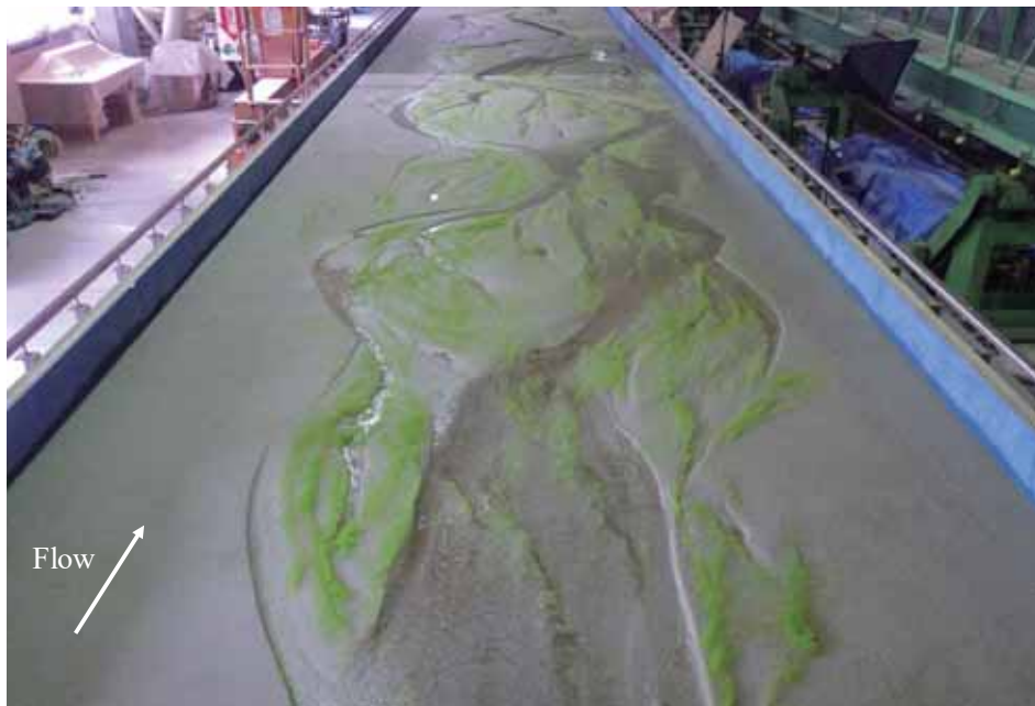
図-4 ベントグラス定着 (Case A-1) から12日後の生育状況、砂州全域に植生が定着しつつも、縦断方向に局所的に高密度で生育する様子を確認。
