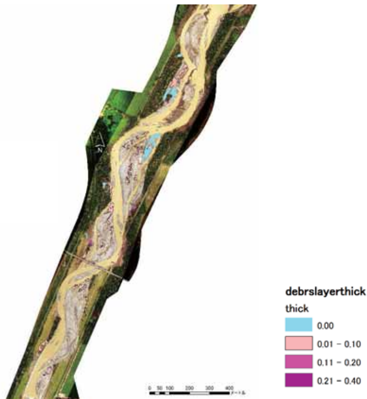
図-8 流木現地調査結果（北開水エコンサルタント提供）における「積層」（無次元の定数）情報についてポリゴンの分布で示したもの
