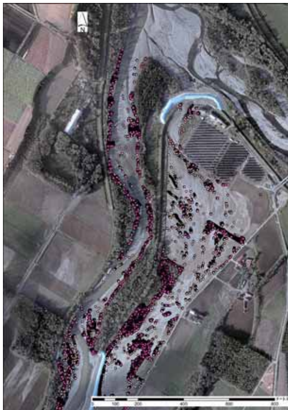
図-3 オリジナルデータと地表面高さの差分値(図-2)における0.2m~1.0mの領域(淡色)と1.0m~2.0mの領域(濃色)をポイントデータとして抽出したもの
