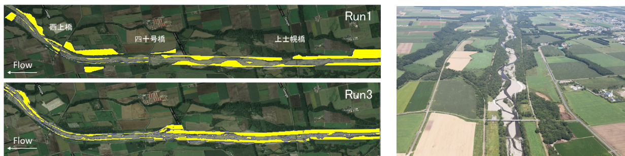
図-3（左図）Run 1とRun 3の植生分布の初期条件（黄色領域は植生域に該当。ただし、堤内地側の植生は未設定）、右写真）同じ場所のH23年度写真（開発局提供）、樹木が主流路側に向かって張り出す様子が分かる。
