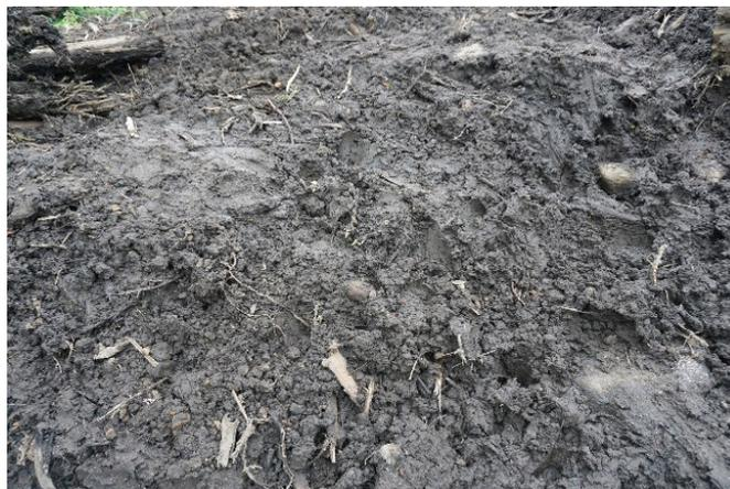
図8 家屋を破壊した黒色の細粒土
