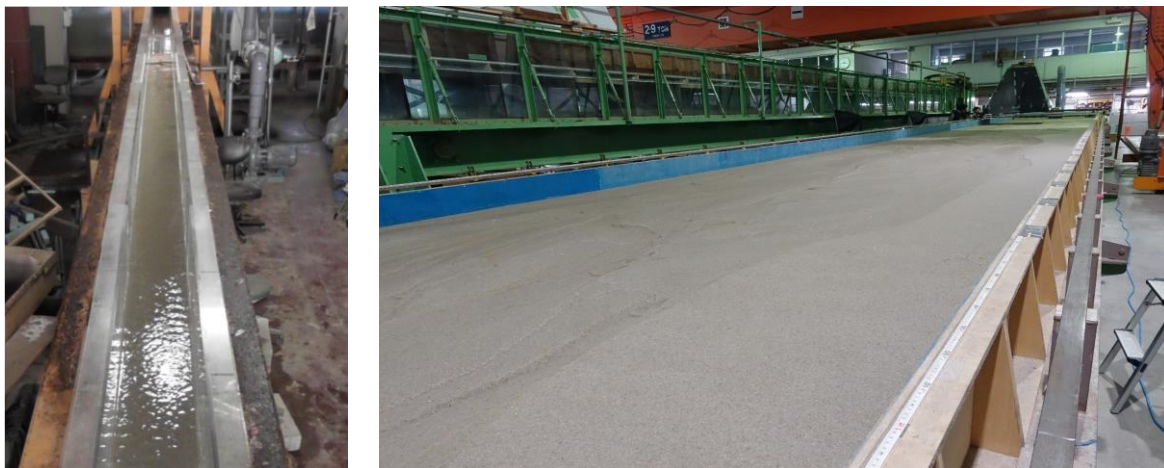
図-1 実験水路, 左) 交互砂州形成, 右) 網状流路形成
