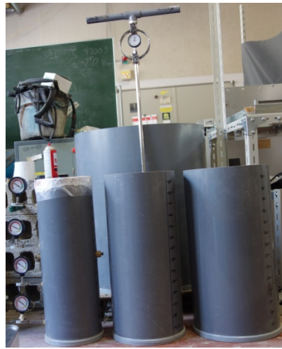
図9 室内におけるキャリブレーションのためポータブルコーン貫入
