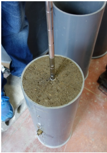
図9 室内におけるキャリブレーションのためポータブルコーン貫入
