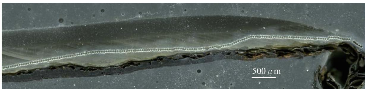
図10 LA-ICP-MS分析後のレーザーを照射したスポット痕
