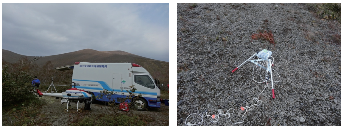
図7 左、北海道開発局所有の無人ヘリコプターと無人ヘリコプターを操作するオペレート室を完備した専用車両。右、子機を実際に設置した状況
