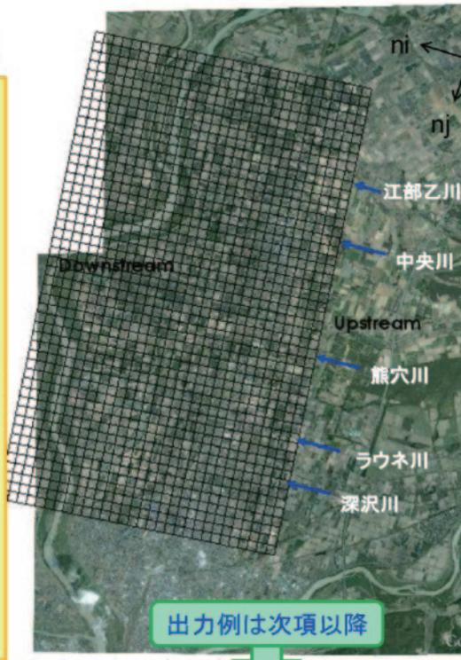
図-3.1 Nays2DFlood による中小河川流域への氾濫解析適用例(10)
