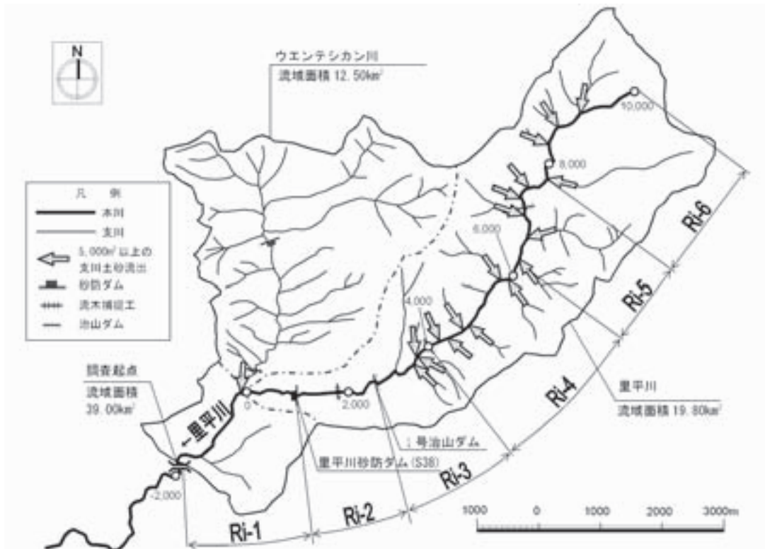
図-4 里平川流域と土砂供給源となった支川分布
