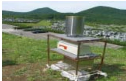
(b) 雨量計設置状況
