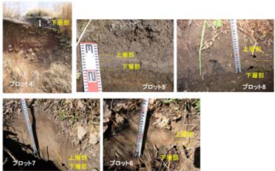
写真-5 水無川流域北上木場地区を南東方向に流下した熱風部の堆積物 （流れ方向:4'⇒5'⇒8⇒7⇒6）（2006年2月21日,3月10日撮影）
