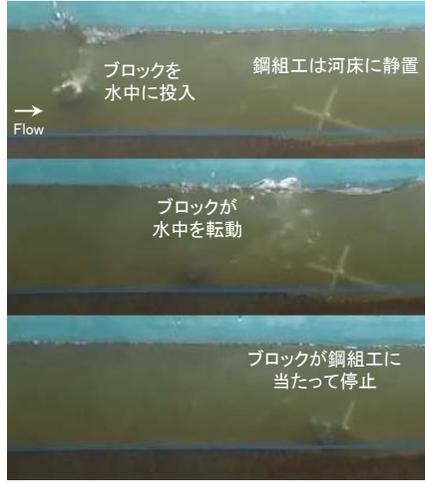
実験写真（ブロック受け止め実験）
