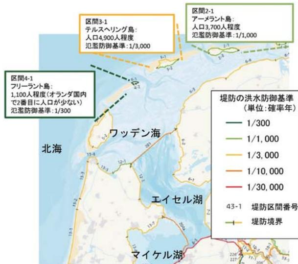
図参2-19 新しい氾濫防御基準：オランダ北部の例 (参考文献<sup>19)</sup>をもとに作成)
