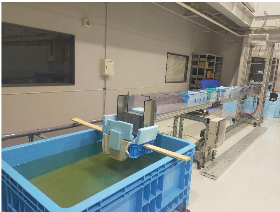
図1 水理模型実験に用いた可変傾斜循環型開水路実験装置の全体像（富山大学水理実験室）
