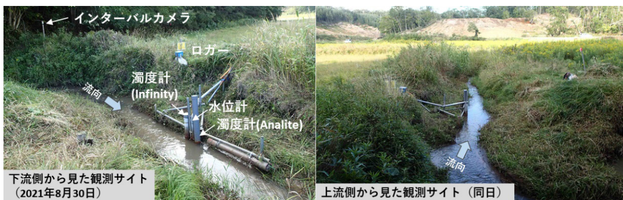
図3-2 流出観測サイトでの観測機材設置状況
