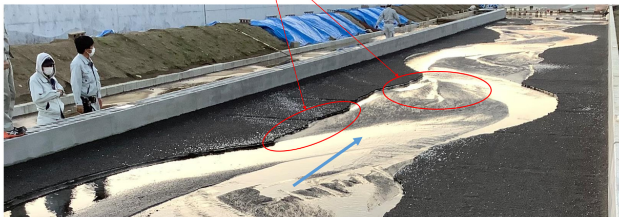
図-3 石狩実験水路（水路長60m，水路幅6m，初期低水路幅1.54m，河床勾配1/150）における蛇行流路への細粒土砂の堆積（未発表）
