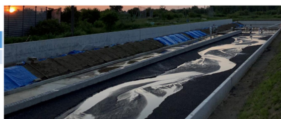
図-2 蛇行流路における細粒土砂の堆積傾向（W. M. van Dijk et al, 2013 6) より引用）
