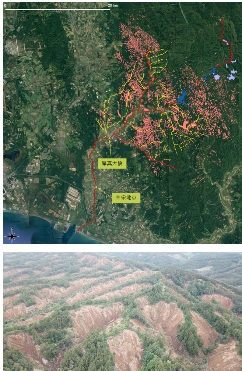
図-1 厚真川流域における調査地概要、 上) 厚真川流域における崩壊図（桃色：崩壊地，地理院タイルより） 下) ハビウ川流域の斜面崩壊の様子（2018年9月8日ドローン撮影）
