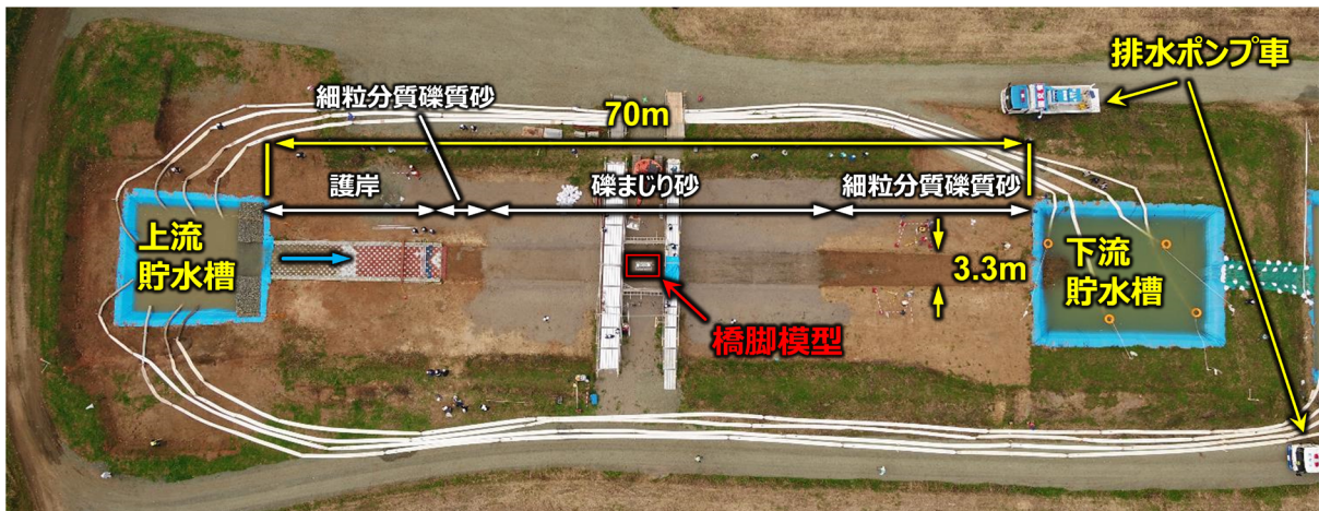
図-1 屋外大型開水路の概要
