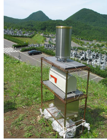
(b) 雨量計設置状況
