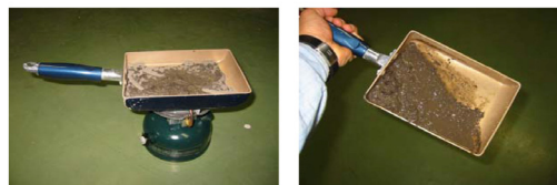
写真-3 森林表層土の保水性と飽和時の流動化の野外実験(上；実験状況、下；飽和土の流動化実験)
