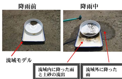
写真-2 流域認識のための流域モデルを用いた簡易な降雨実験
