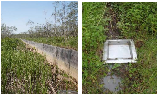
図3 久著呂地区土砂調整地(上:左岸土砂調整地での堆積土砂調査位置, 左下:人工ケルミ, 右下:堆積土砂調査のための採泥器 0.22m×0.22m)
