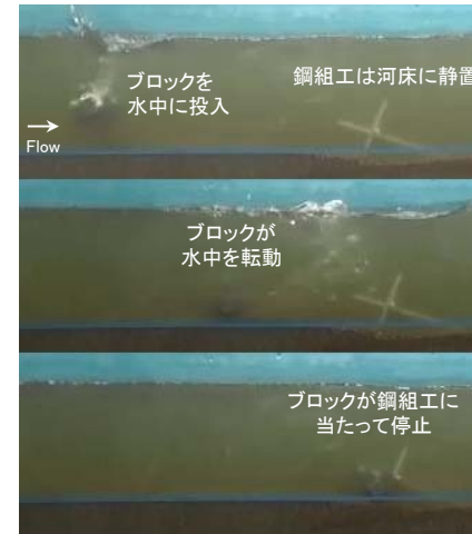
実験写真（ブロック受け止め実験）
