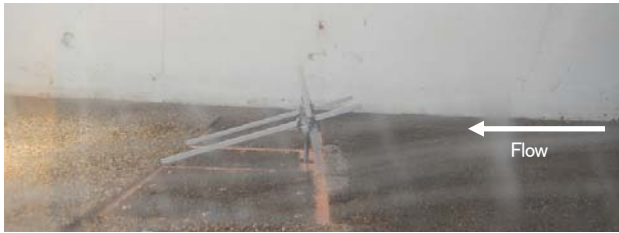
写真-3 抗力係数算定実験 (通水前, 河床下部に分力計)
