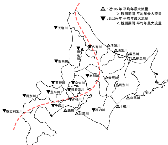
図 2 北海道内一級河川の平均年最大流量増減区分図 (区分線は図 1 と同じ)
